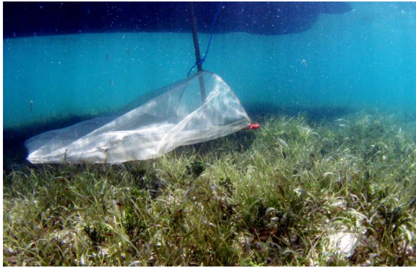
Figure II-9. Filet épi-benthique utilisé pour collecter l'épifaune vagile (Photographie C. Bouchon).
