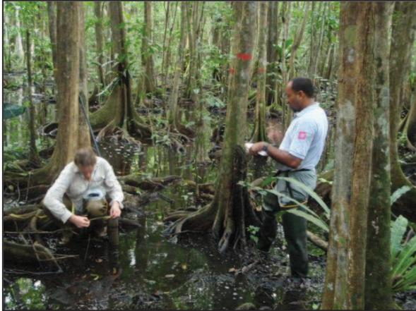
Mesure de la hauteur et de la conductivité de la nappe dans les piézomètres avec Modeste Salignat, garde au Parc National. (Photo : R. Rossignol)
